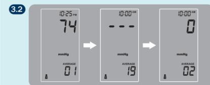
第一次量測完成後，機器將倒數20秒，自動加壓進行第二次量測。兩次測得的收縮壓如果差值在15mmHg 以上，間隔秒數將延長為40秒。
