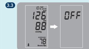
第三次測量完成後，機器會發出 "嗶嗶" 聲，並顯示三次血壓測量的平均值。量測完成後，可按 **⏻** 關閉電源或等待3分鐘讓機器自動關機。
